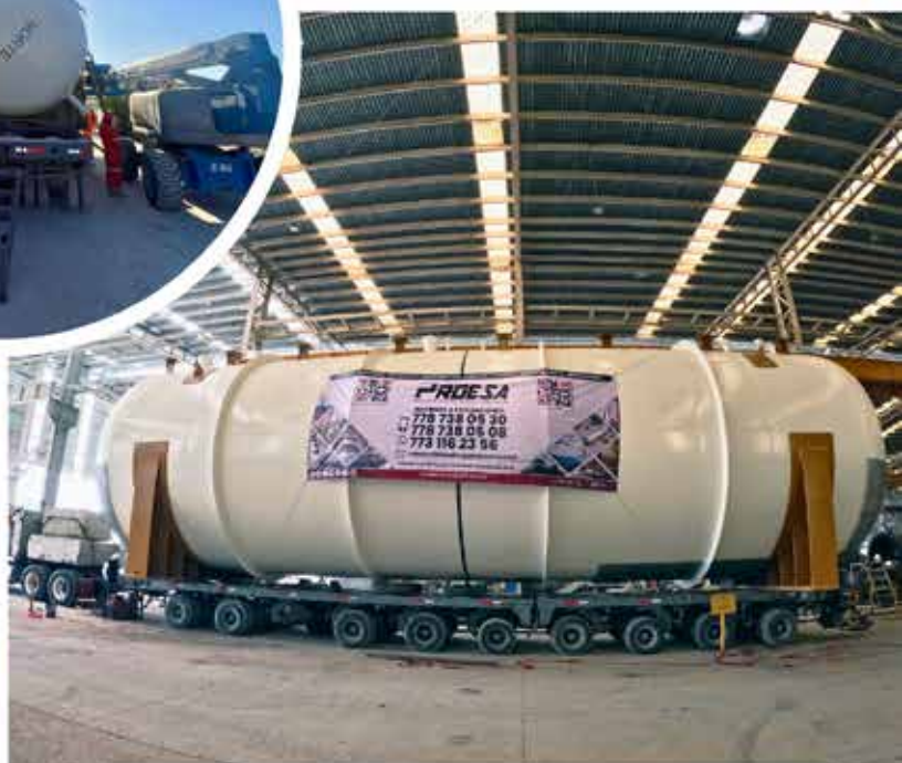
FA-88201 Separador de Amina con Contenido CO2
